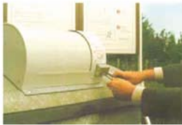
מערכת נעילה מכנית למיכל שעל הפח: מכניסים כרטיס חכם, פותחים המיכל, מכניסים האשפה, מוציאים הכרטיס
